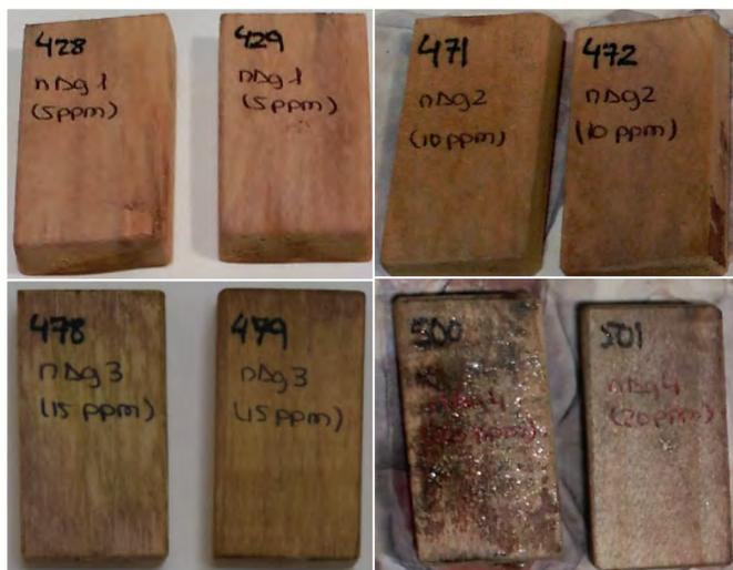
Figura 2. De izquierda a derecha, arriba y abajo: Probetas tratadas con 10, 20, 40 y 80 mg · ml<sup>-1</sup> de oligómeros de quitosano tras el periodo de estabilización en condiciones de laboratorio durante 1 semana.
