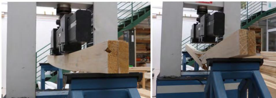
Figura 5. Ensayo de flexión en viga dúo de chopo con refuerzo GFRP.
