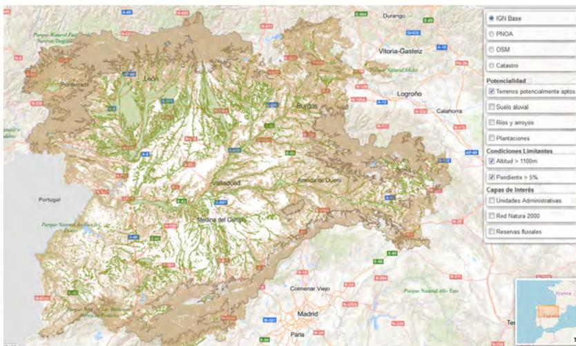
Figura 2: Captura del visor de mapas de potencialidad de terrenos, con la visualización de limitante de altitud y pendiente activos
